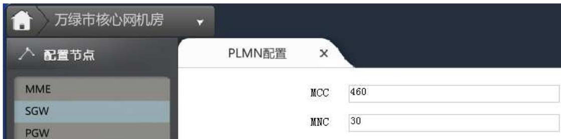
图 3.5-14 万绿市核心网机房 SGW 的 PLMN 配置
