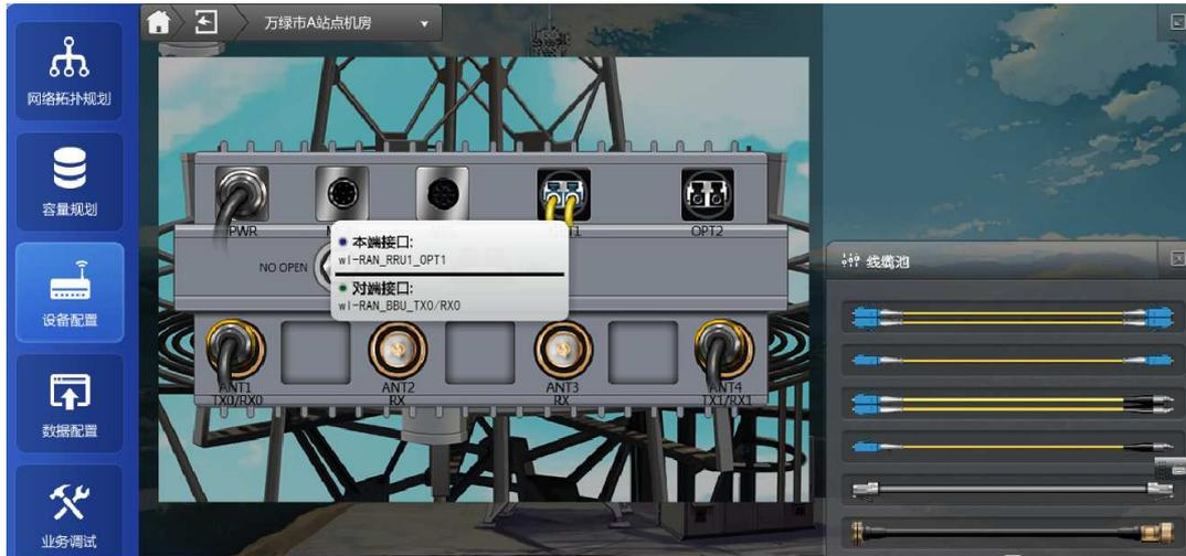
图 3.2-11 万绿市 A 站点机房 RRU 线缆连接图
