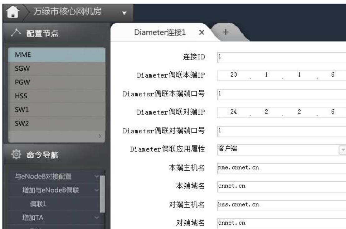
图 3.5-5 万绿市 MME 与万绿 HSS 的 Diameter 连接
