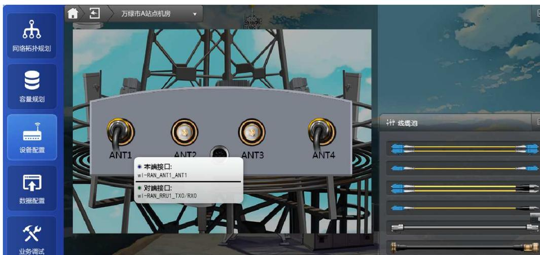
图 3.2-12 万绿市 A 站点机房 RAT 线缆连接图
