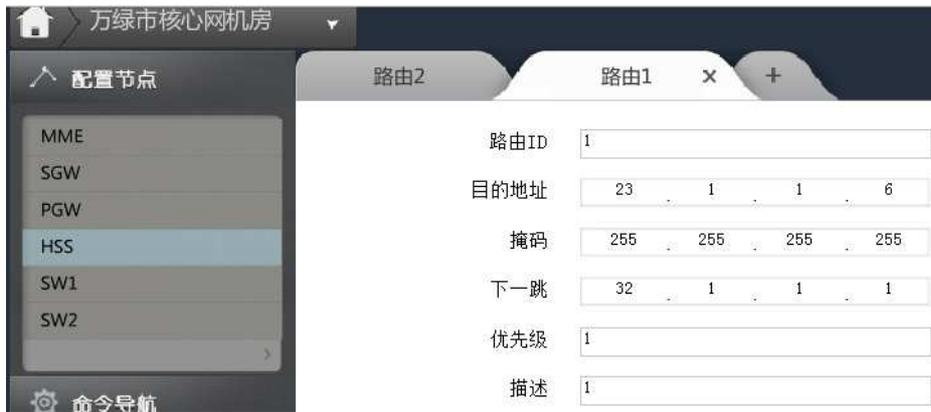
图 3.5-29 万绿市核心网机房 HSS 的路由配置
