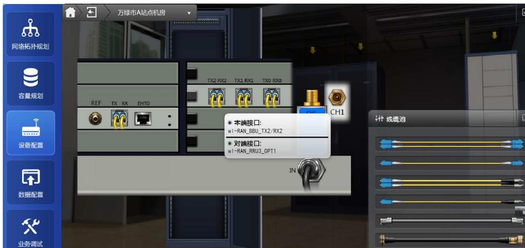
图 3.2-10 万绿市 A 站点 BBU 线缆连接
