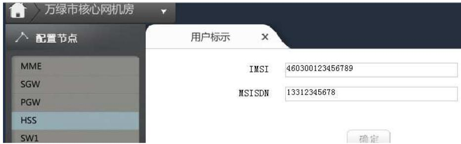
图 3.5-32 万绿市核心网机房 HSS 用户标示配置
