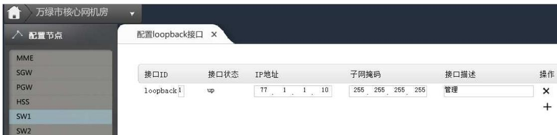
图 3.5-35 SW1 配置 loopback 接口
