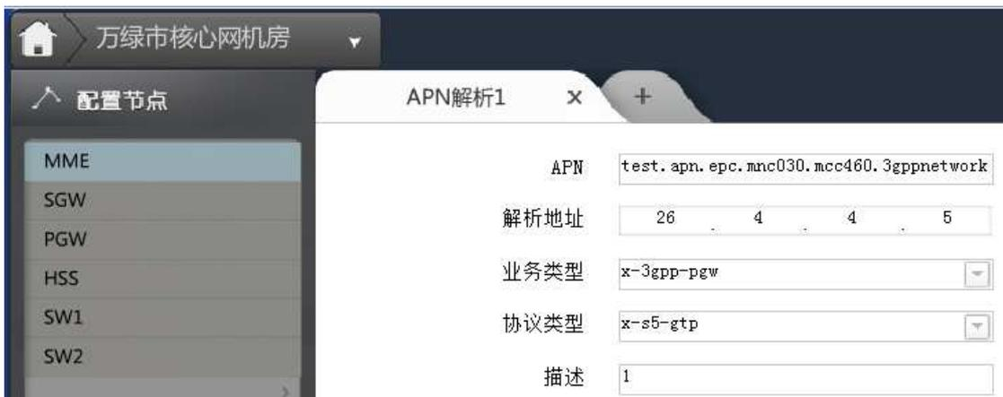
图 3.5-8 万绿市核心网机房 MME 的 APN 解析 1
