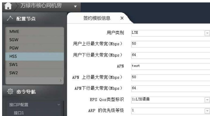
图 3.5-30 万绿市核心网机房 HSS 签约模板信息配置
