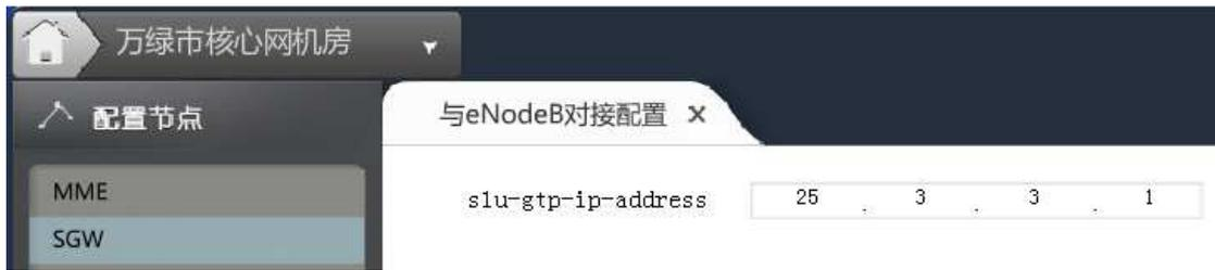
图 3.5-16 万绿市核心网机房 SGW 与 eNodeB 对接配置
