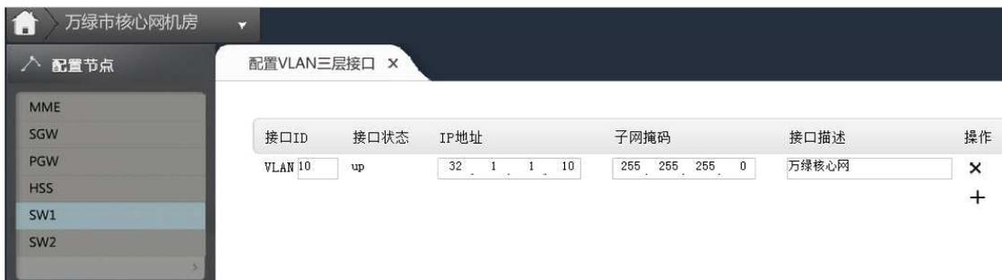
图 3.5-36 SW1 配置 VLAN 三层接口
