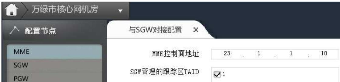
图 3.5-7 万绿市核心网机房 MME 与 SGW 对接配置
