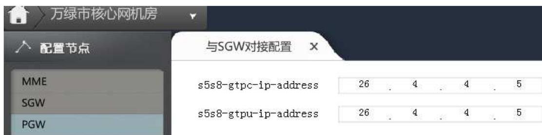
图 3.5-23 万绿市核心网机房 PGW 与 SGW 对接配置
