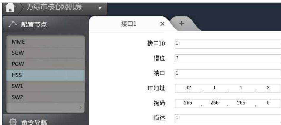
图 3.5-28 万绿市核心网机房 HSS 接口配置
