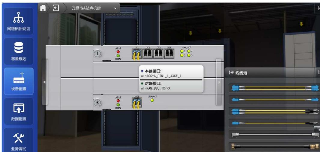
图 3.2-14 万绿市 A 站点机房 PTN 线缆连接图
