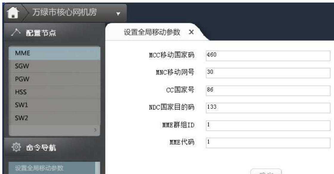
图 3.5-1 万绿市核心网机房 MME 设置全局移动参数
