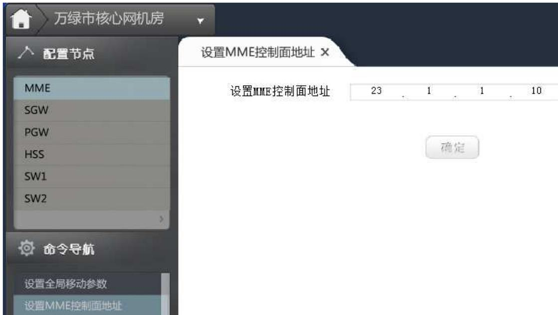
图 3.5-2 万绿市核心网机房 MME 设置 MME 控制面地址
