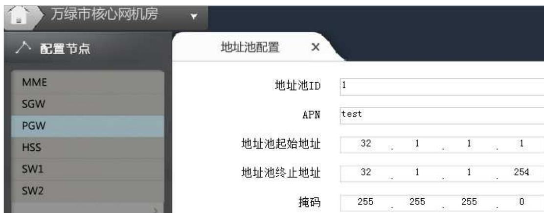
图 3.5-24 万绿市核心网机房 PGW 地址池 N 配置
