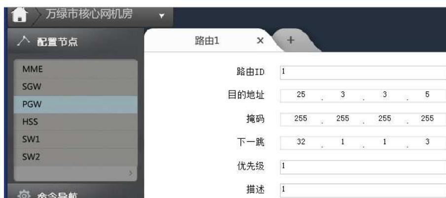
图 3.5-26 万绿市核心网机房 PGW 的路由配置
