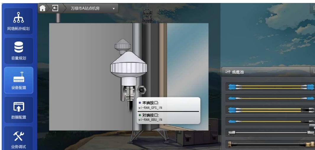
图 3.2-13 万绿市 A 站点机房 GPS 线缆连接图
