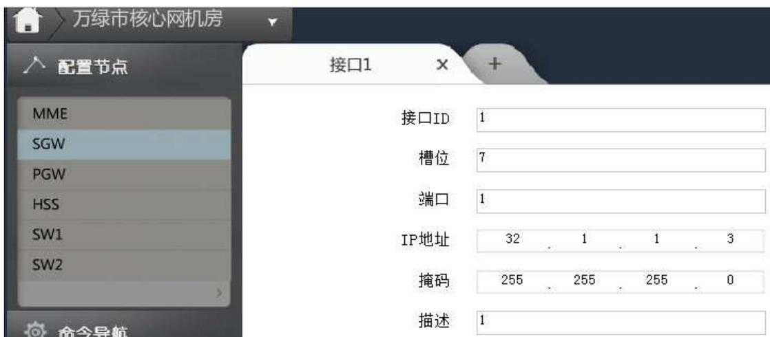
图 3.5-18 万绿市核心网机房 SGW 接口配置
